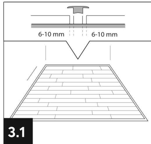
Есть особые случаи, когда требуется устройство дополнительных расширительных швов, которые закрываются стыковочным профилем (порожком):
